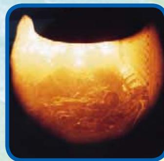
**5** Les résidus de la combustion en fin de grille sont appelés mâchefers. Ils sont extraits du four par l'intermédiaire d'un tambour, puis refroidis et éteints dans un extracteur. Ils sont évacués ensuite sur des bandes transporteuses, déferpillés par séparateur magnétique, stockés dans une fosse, puis évacués par transport routier.
